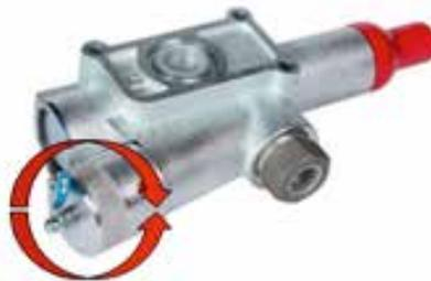
Zum Heben der Mulde wird das Luftschaftventil auf „Heben“ gestellt. Zum Senken der Mulde wird das Ventil auf „Senken“ gestellt. Zur Unterbrechung der Funktionen und für den Fahrbetrieb wird das Luftschaftventil auf „Halten“ gestellt. Die Funktionen sind mit der Hebelstellung dosierbar. Zum Senken der Mulde wird das Ventil auf „Senken“ gestellt.
