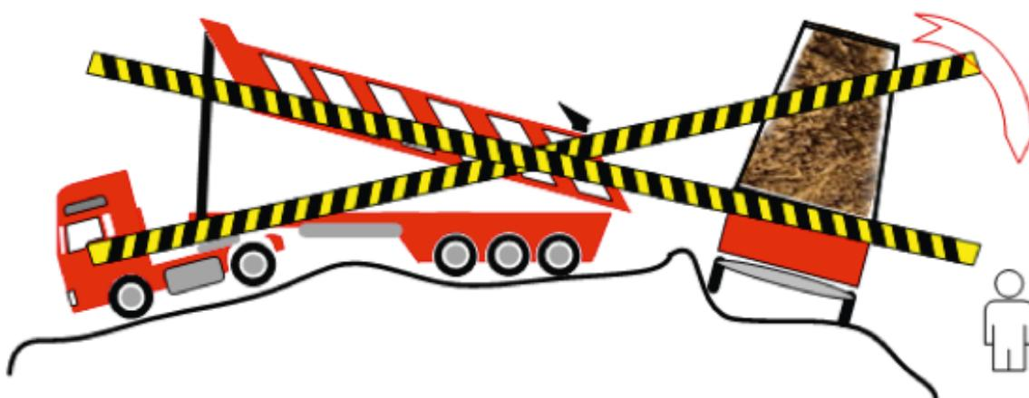
Der Aufenthalt im unmittelbaren Arbeitsbereich – während des Kippvorgangs oder bei aufgestellter Kippmulde – ist **strengstens** untersagt. Lassen Sie Ihr Fahrzeug während des
